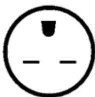
220/240 V AC NEMA 6-15R faza razdvajanja
