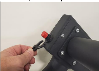
Håndleddsstropp for dødmannsklips løs
