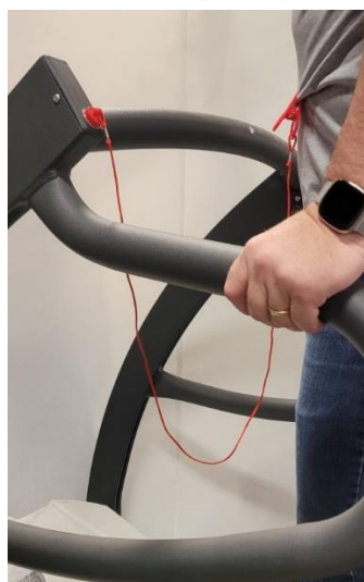
Przymocowany klips magnetyczny
