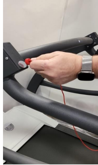
Amarre magnético desprendido
