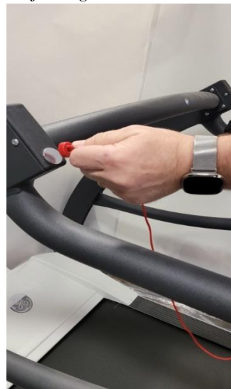
Anclaje magnético desconectado
