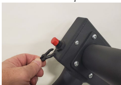
Håndleddsstropp for dødmannsklips løs
