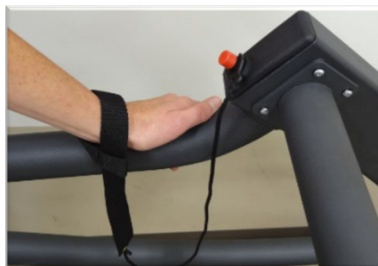
Clipe do tirante com pulseira colocado
