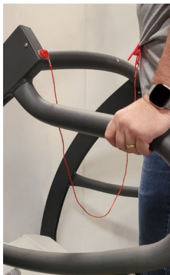
Tirante magnético colocado
