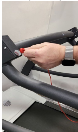
Amarre magnético desprendido
