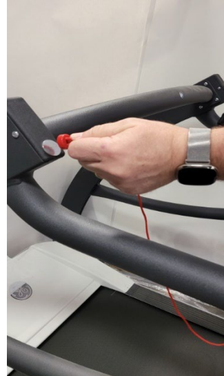
Anclaje magnético desconectado
